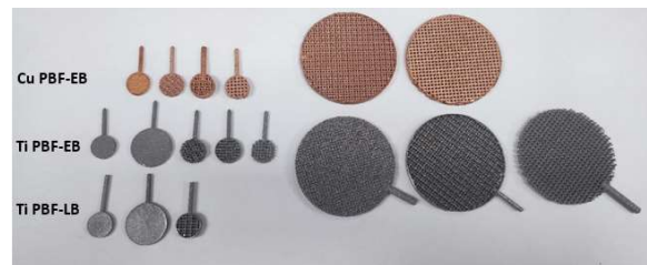
Figura 1. Soportes metálicos obtenidos mediante de fabricación aditiva de cobre y titanio utilizados en el proyecto para su modificación como fotoelectrodos.
